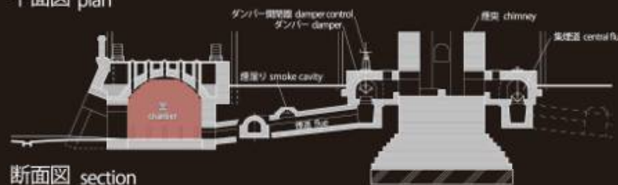
煙道の構造 Structure of flue
